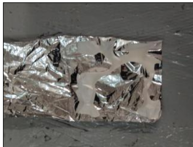
Прототип «Импульс-С» модель 1 с частичным разрушением блока рабочего тела (характеристики двигателя сохранились)
